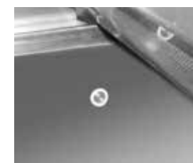
Sonda di livello acqua in vasca water level sensor
